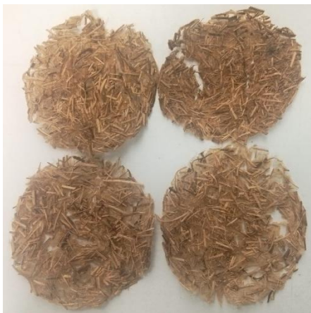
Figura 8. Paneles circulares producidos con raquis de banano al finalizar el proceso de secado de la formulación F3.
