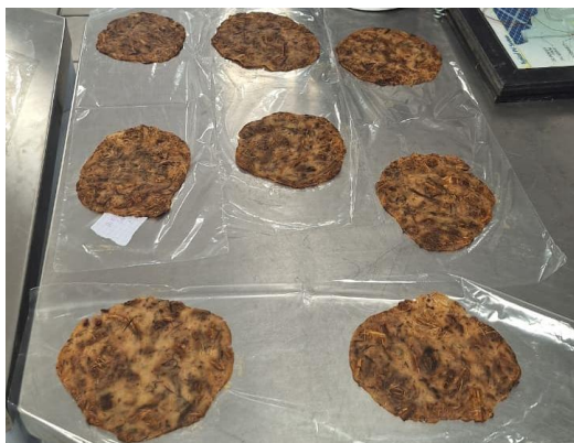
Figura 5. Paneles circulares elaborados con raquis del banano después de la compresión.
