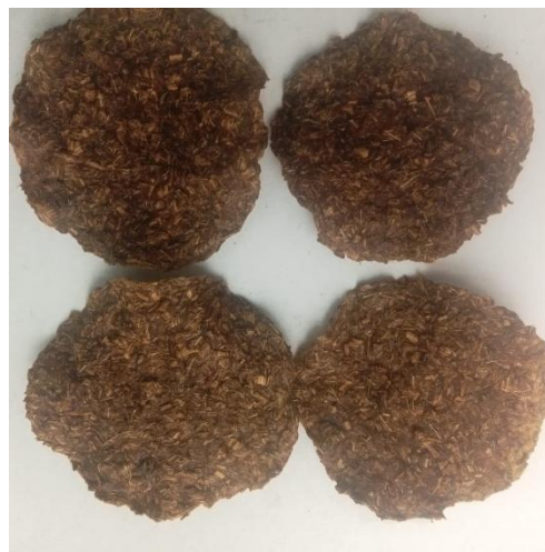
Figura 6. Paneles circulares producidos con raquis de banano al finalizar el proceso de secado de la formulación F1.
