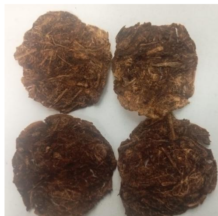
Figura 7. Paneles circulares producidos con raquis de banano al finalizar el proceso de secado de la formulación F2.
