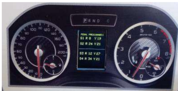
Figura 10: Tablero con pantalla LCD.
