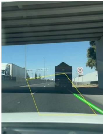
Figura 6. Detección de carriles bajo condiciones de sombra con pérdida parcial de continuidad en las líneas viales.
