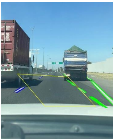
Figura 8. Detección de carriles en salida lateral curva con presencia de sombras y obstrucciones parciales.
