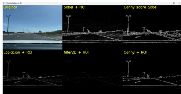
Figura 2. Aplicación de combinación de filtros de detección de bordes.
