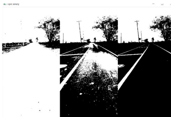
Figura 1. Resultados de la segmentación de líneas viales mediante distintos umbrales de binarización.
