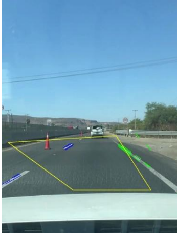
Figura 5. Detección de carriles con presencia de falsos positivos fuera de la ROI.
