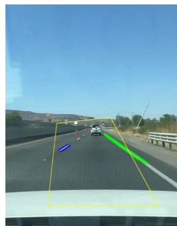
Figura 4. Detección de carriles en tramo recto con condiciones óptimas de iluminación.
