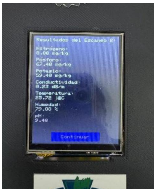
Figura 4. Resultados del escaneo de suelo mediante dispositivo portátil en sistema de sustrato inerte.
