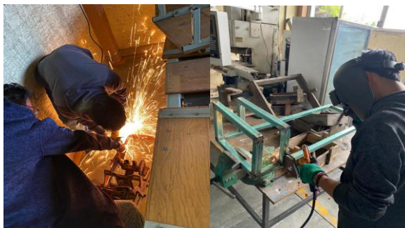
Figura 4. Estudiantes de la carrera de Ingeniería Electromecánica cortando y soldado la surcadora de acuerdo al diseño previamente elaborado. Fuente: Elaboración propia.
