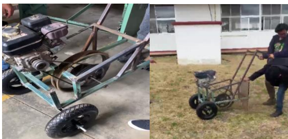
Figura 6. Prueba de funcionamiento de la surcadora en instalaciones del ITSSNP. Fuente: Elaboración propia.
