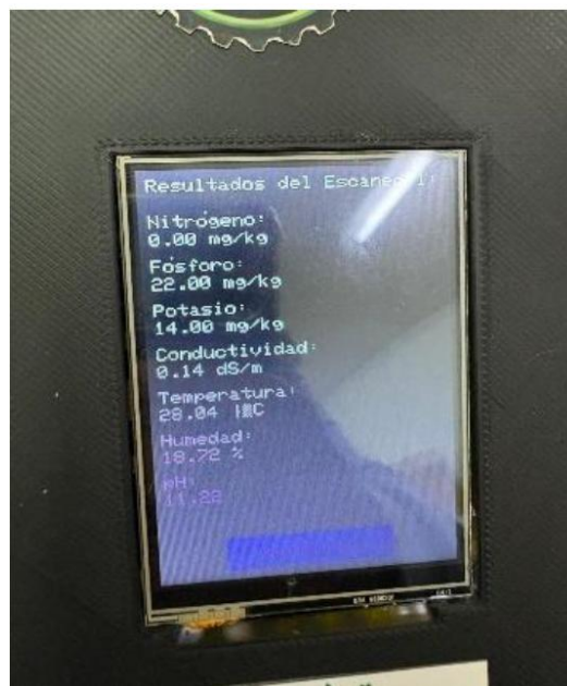
Figura 3. Resultados del escaneo de suelo mediante dispositivo portátil en sistema traspatio.
