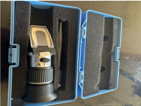
Figura 2. Refractómetro ocupado para realizar las pruebas para la determinación de los grados °Brix
